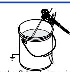
Pistole in den Schmutzeimer richten und mit sauberer Flüssigkeit mehrmals kurz abziehen, um Schnitzreste aus dem vorderen Pistolenabschnitt zu beseitigen.
