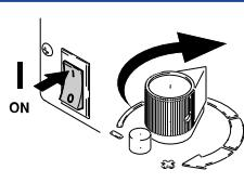
Schalten Sie das Gerät wieder ein und erhöhen Sie den Druck so lange, bis das Gerät zu arbeiten beginnt.
