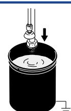
Stellen Sie das Ablaßrohr und das Ansaugrohr in einen Eimer Wasser.
