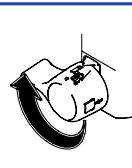
Drehe das AutoCleanventil zum Starten des Reinigungsprozess.
