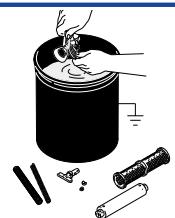
Schrauben Sie Düse und Dünschutz von der Pistole ab. Reinigen Sie den Pistolenfilter, das Ablaßsieb, die Düse, den Dünschutz und den Verteilerfilter mit Wasser und einer Bürste.
