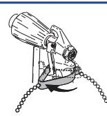
Den Clip der Abzugssperre um 90° drehen, um den Abzug in der geöffneten Stellung zu verriegeln.
