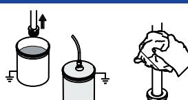
Nehmen Sie das Ansaug- und Ablaßrohr aus der Farbe. Legen Sie das Ablaßrohr in einen Schmutzeimer und wischen Sie das Ansaugrohr ab.
