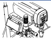
Reinigen Sie das Gerät, den Schlauch und die Pistole von außen nur mit einem Lappen und Wasser oder mineralischen Reinigungsmittel.
