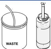
Stellen Sie das Ablaßrohr in einen Schmutzeimer und das Ansaugrohr in einen Pump Armor<sup>TM</sup>-Behälter.
