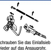
Schrauben Sie das Einlaßsieb wieder auf das Ansaugrohr, montieren Sie den Gerätefilter und den Distanzring, und bauen Sie den Filter, die Düse und den Dünschutz wieder an die Pistole.
