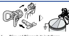
Düse und Dünschutz installieren und Pistole in einen Schmutzeimer richten und kurz abziehen, um die Düse zu reinigen. Düse bei Bedarf umdrehen.
