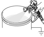
Halten Sie den Abzug der Pistole bis der Druck entlastet ist.
