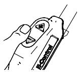
Drücke „Auf“ und „Ab“ der E-Steuerung zum erhöhen oder verringern des Arbeitsdruck. Eingestellt bei 3 Bar.
