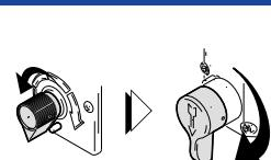
Drehen Sie den Druckregler ganz nach unten. Öffnen Sie das Spülventil.
