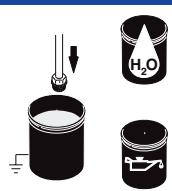
Legen Sie das Ansaugrohr in die bereitgestellte Reinigungsflüssigkeit.
