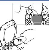
Füllen Sie die Halsdichtungsmutter mit TSL<sup>TM</sup> (mineralischen Reinigungsmittel).
