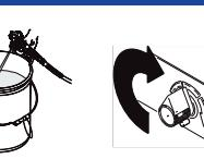
Um die Farbe aus Schlauch und Pumpe wieder verwenden zu können, ziehen Sie den Abzug der Pistole und richten diese in den Farbeimer. Erhöhen Sie den Druck. Wenn Reinigungsflüssigkeit austritt, lassen Sie den Pistolenabzug los.
