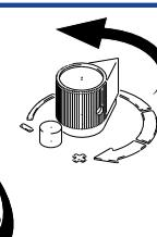
Schalten Sie das Gerät aus ("OFF"), drehen Sie den Druckkontrollknopf in die niedrigste Stellung und drehen Sie das Spülventil in Spülposition (nach unten).
