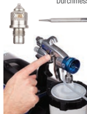
2. Abzugshebel zurückziehen, um die Nadel zu lösen.
