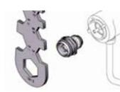
Montieren Sie den neuen Diffusor an die Pistole. Drehmoment 18-19Nm
