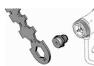
Entfernen Sie den Diffusor mittels des Pistolen Werkzeug's.
