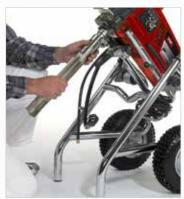
Einrasthebel nach unten schieben, Materialschlauch abschrauben.
