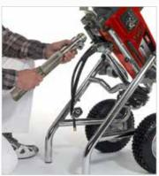
Unterpumpe bis zur Öffnung hervorschieben, dann nach unten herausheben.
