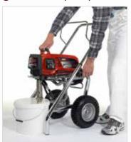
Seitlichen schwarzen Sicherungshebel nach unten und gleichzeitig das Gerät am oberen Griff nach oben heben bis es einrastet. Gerät wieder leicht anheben dann seitlichen schwarzen Sicherungshebel nach unten und Gerät langsam herunterlassen.
