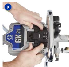
Zugangsabdeckung aufschieben und anheben
