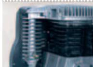
**Zwischen- und Nachkühler** mit großen Kühllamellen sorgt für niedrige Drucklufttemperaturen
