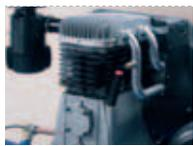
Zweistufig verdichten des **Zweizylinder-Aggregat** aus hochwertigem Grauguss, ruhiger, vibrationsarmer Lauf.
