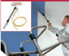
Rollen mit Airless-Technik: Das Beschichtungsmaterial wird durch die Airless-Anlage automatisch vom Gebinde in die Farbwalze gefördert. Bequemes und rationelles Arbeiten ohne Eimerschleppen und Eintauchen in das Gebinde.
