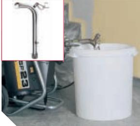
Neben Behältern bieten die SuperFinish Anlagen die Möglichkeit Material direkt aus Gebinden oder Containern zu verarbeiten.
